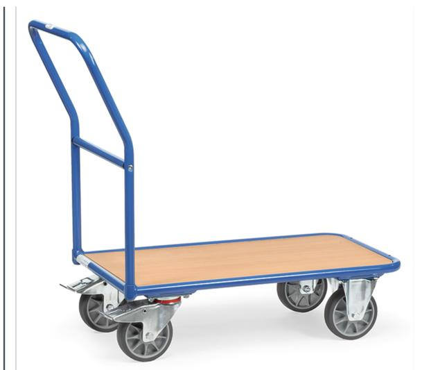
Ensemble mécano-soudé, revêtement époxy bleu RAL 5007 uniquement. Plateforme en mélaminé surface effet hêtre, 2 roues pivotantes et 2 roues fixes à bandage TPE, moyeu à roulement à billes central. Freins sur roues pivotantes conformément à la Norme EN 1757-3.
