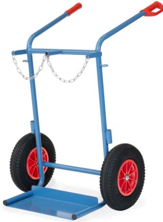
Stahlflaschenkarre aus Stahlrohr geschweißt, pulverbeschichtet blau RAL 5007. Flaschenhalterungen mit Kettensicherung. Räder mit Luftbereifung, Naben mit Rollenlager. Schweißdrahtkocher an beiden Holmen.
