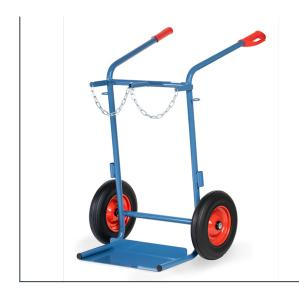
Stahlflaschenkarre aus Stahlrohr geschweißt, pulverbeschichtet blau RAL 5007. Flaschenhalterungen mit Kettensicherung. Räder mit Vollgummibereifung, Naben mit Rollenlager. Schweißdrahtköcher an beiden Holmen.
