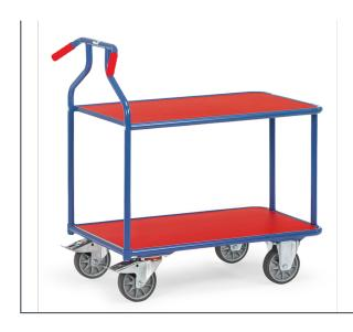
Stahlrohr-Konstruktion, pulverbeschichtet, dauerhaft oberflächengeschützt, schlag- und kratzfest. 2 Böden Holzwerkstoffplatte mit roter Kunststoffoberfläche. 2 Lenkund 2 Bockrollen, TPE-Bereifung, Naben mit Rillenkugellager. Feststeller an den Lenkrollen, gemäß der Europäischen Norm EN 1757-3 (Sicherheit von Plattformwagen). Tragkraft obere Ladefläche 200 kg.
