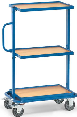
Stahlrohr- und Profilstahl-Konstruktion, pulverbeschichtet, blau RAL 5007. 3 Holzwerkstoffplatten, Rand 13 mm hoch. 2 Lenk- und 2 Bockrollen, TPE-Bereifung, Naben mit Rillenkugellager. Feststeller an den Lenkrollen, gemäß der Europäischen Norm EN 1757-3 (Sicherheit von Plattformwagen). Tragkraft obere und mittlere Ladefläche 50 kg.
