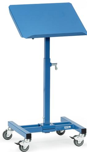
Für Kunststoffkästen, Stahlblechkästen, Drahtkörbe usw., höhenverstellbar und fahrbar. Profilstahl-/Rohrkonstruktion mit Stahlblechplattform mit einseitiger Anlagekante, neigbar um 15° und 30°. Höhenverstellbar im Raster von 25 mm. Pulverbeschichtet brillantblau RAL 5007. 4 Lenkrollen mit TPE-Bereifung, Naben mit Gleitlagerung. Feststeller an 2 Lenkrollen gemäß der Europäischen Norm EN 1757-3 (Sicherheit von Plattformwagen).
