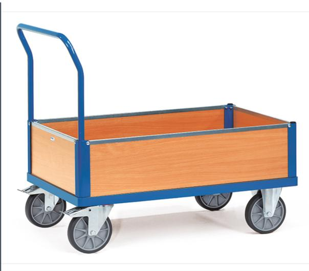
Stahlrohr und Profilstahl geschweißt, pulverbeschichtet RAL 5007, Plattform Holzwerkstoffplatte, Oberfläche Buchendekor. 4 Wände aus Holzwerkstoffplatte, Oberfläche Buchendekor, Wandhöhe 250 mm. Alle 4 Wände sind einzeln herausnehmbar. 2 Lenk- und 2 Bockrollen, TPE-Bereifung, Naben mit Rillenkugellager. Feststeller an den Lenkrollen, gemäß der Europäischen Norm EN 1757-3 (Sicherheit von Plattformwagen).
