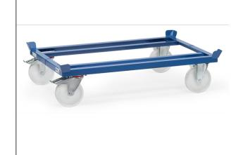
Für Flachpaletten und Gitterboxen. Robuste Winkelstahl-Schweißkonstruktion, mit 4 Fangecken, pulverbeschichtet, blau RAL 5007. 2 Lenk- und 2 Bockrollen, Polyamid-Räder, Naben mit Rollenlager, Feststeller an den Lenkrollen, gemäß der europäischen Norm EN 1757-3 (Sicherheit von Plattformwagen). Geringer Rollwiderstand, hohe chemische Beständigkeit, nicht kreidend = spurlos. Fahrgeräusche.
