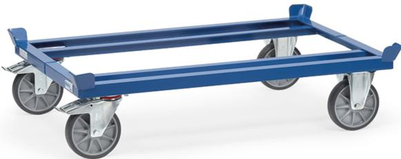
Für Flachpaletten und Gitterboxen. Robuste Winkelstahl-Schweißkonstruktion, mit 4 Fangecken, pulverbeschichtet, blau RAL 5007. 2 Lenk- und 2 Bockrollen, TPE-Bereifung, Naben mit Rillenkugellager, Feststeller an den Lenkrollen, gemäß der europäischen Norm EN 1757-3 (Sicherheit von Plattformwagen). Standard-Beräderung für mittlere Belastungen. Geräuscharmer Lauf.
