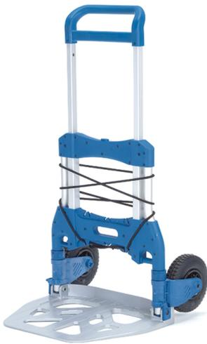
Paketroller - erstklassig verarbeitete Aluminium-Stahlrohrkonstruktion mit Aluminium-Schaufel und hochwertigen Kunststoffteilen. Räder mit Luftbereifung, Naben mit Rollenlager. Griffbügel aus handsympathischem rutschsicherem Material. Elastisches Spannband und Spannleiste zur Sicherung des Transportgutes. Schaufel und Räder mit einem Handgriff an- und abklappbar, Griffholm einschiebbar. In wenigen Sekunden einsatzbereit.
