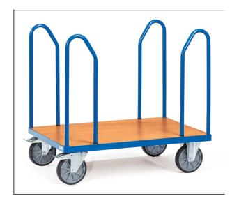
Seitenbügelwagen aus Stahlrohr und Profilstahl geschweißt, pulverbeschichtet brillantblau RAL 5007, Plattform Holzwerkstoffplatte, Oberfläche Buchendekor. Mit 4 Bügeln. Bügelhöhe 720 mm. 2 Lenk- und 2 Bockrollen, TPE-Bereifung, Naben mit Rillenkugellager. Feststeller an den Lenkrollen, gemäß der Europäischen Norm EN 1757-3 (Sicherheit von Plattformwagen).
