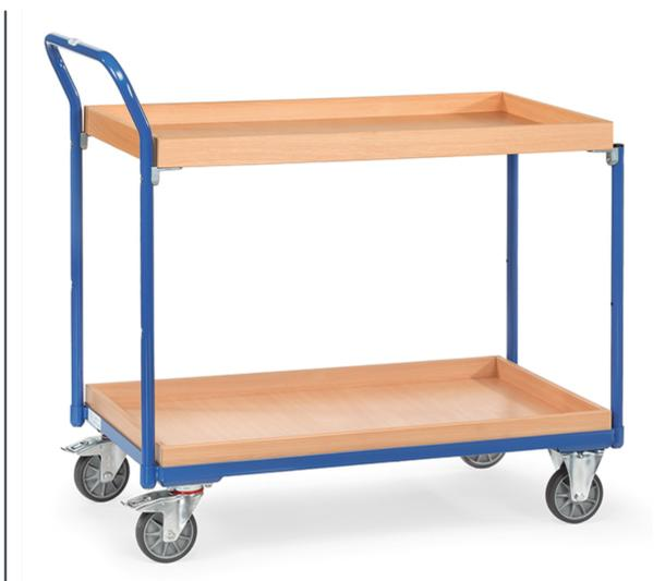
Ensemble mécano-soudé, revêtement époxy bleu RAL 5007 avec 2 caissettes en mélaminé surface effet hêtre, rebord de 45 mm, barre de poussée verticale. Charge maximum étagère haute: 80 kg. 2 roues pivotantes et 2 roues fixes à bandage TPE, moyeu à roulement à billes central. Freins sur roues pivotantes. Dimensions intérieures de la caissette étagère haute: 815 x 455 x 45 mm.
