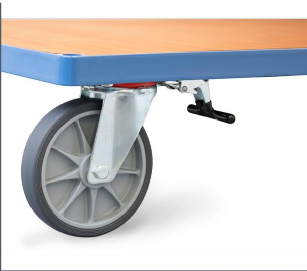
Mehrpreis für Ausstattung mit Richtungsfeststeller. Anstelle der 2 Bockrollen werden 2 Lenkrollen mit Richtungsfeststeller (4x 90° Arretierung) montiert. Dadurch wird ein guter Geradeauslauf in Längs- und Querrichtung möglich. Der feststehende Bedienhebel ist in jeder Rollenposition von der Längsseite aus zu bedienen. Mehrpreis pro Wagen. NUR auf Standard TPE-Bereifung.
