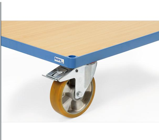
Mehrpreis für Räder mit Polyurethan-Bereifung anstelle der Standard-Beräderung. Mehrpreis pro Wagen für Radgröße 125 x 40 mm. Naben mit Kugellager, leichter geräuscharmer Lauf, beständig gegen viele aggressive Medien.
