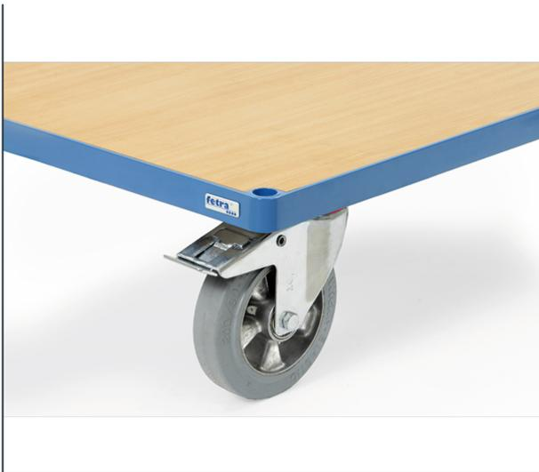
Mehrpreis für Räder mit Elastic-Bereifung blaugrau anstelle der Standard-Beräderung. Mehrpreis pro Wagen für Radgröße 200 x 50 mm. Naben mit Kugellager, leichter elastischer Lauf und hohe Lebensdauer. Nicht kreidend (spurlos).
