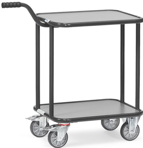
Griffroller in der Ausführung "GREY EDITION". Aus Stahlrohr geschweißt, pulverbeschichtet anthrazitgrau RAL 7016. Mit Holzplattformen. 2 Plattformen mit im Rahmen liegender Holzwerkstoffplatte, Oberfläche mittelgrau. Griff anschraubbar. 2 Lenk- und 2 Bockrollen, TPE-Bereifung (spurlos), Naben mit Rillenkugellager, Feststeller an den Lenkrollen, gemäß der Europäischen Norm EN 1757-3 (Sicherheit von Plattformwagen). Tragkraft obere Ladefläche 100 kg.
